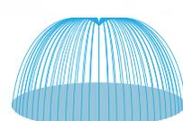
散水直径9.0m(圧力0.2MPa時)
